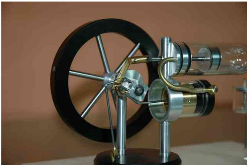
Der Brenner wird etwa halb bis dreiviertel mit Spiritus gefüllt. Anschließend den Deckel mit den Dochten so drehen das der kleine Docht unter dem Glaszylinder steht. Jetzt wird er angezündet. Etwa nach 60 bis 90 Sekunden kann man das Schwungrad andrehen. Es kann passieren das der Brenner leicht überkocht. Also auf jeden Fall nicht auf brennbarem Untergrund betreiben.
