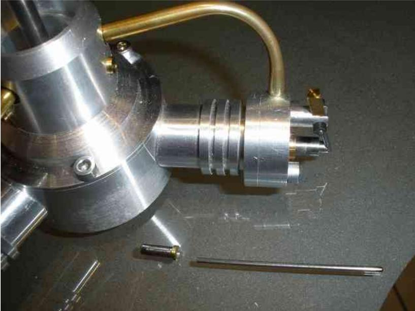
Diese Foto zeigt das vordere Kurbelwellenlager, das kleiner Lager ist exzentrisch gelagert und praktisch die Nocke für die Stößelstangen und zusätzlich die Olive für den Druckluftanschluss.
